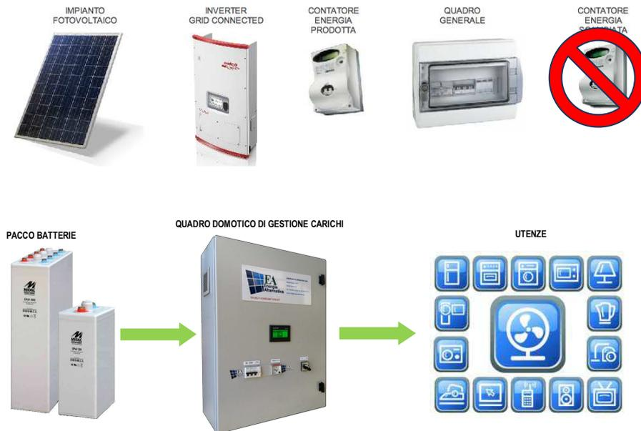
Di notte il quadro di gestione convoglia i carichi privilegiati verso l'inverter ad isola, che utilizzerà l'energia accumulata nel pacco batterie fino ad un livello di scarica di sicurezza. Nel caso in cui il pacco batterie raggiunga un livello troppo basso di energia, per preservarne la longevità il quadro di controllo torna in modalità "On Grid" fino al nuovo giorno per la ricarica fotovoltaica.
